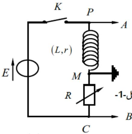
1.1. أعد رسم الدارة و مثل جهة التيار و أسهم الممثلة للتوترات  $u_R(t)$  و  $u_b(t)$  ، الشكل-1 .
